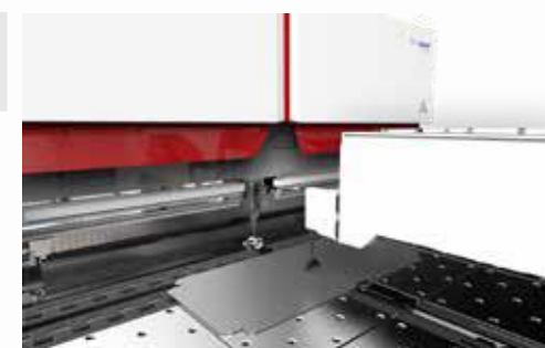
Опорные штифты — центрирующее устройство
