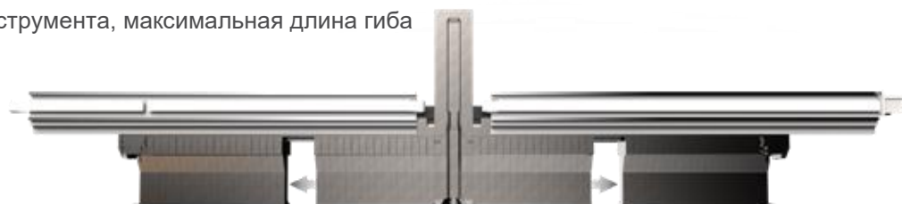
Положение инструмента для гибки с промежутками
